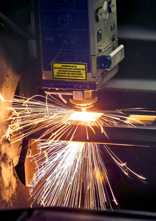
Mit Rohrlasern werden Volumenkörper gelasert.
